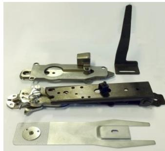
La macchina, su richiesta, viene fornita con KIT attaccabottoni. Sostituendo alcune parti della pinza è possibile eseguire anche lavori di cucitura bottoni.
