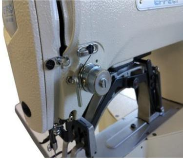
E' possibile memorizzare diversi livelli di tensione del filo a seconda del tessuto utilizzato. Selezionando quello desiderato, il sistema di tensione elettronica, regolerà automaticamente la tensione del filo.
