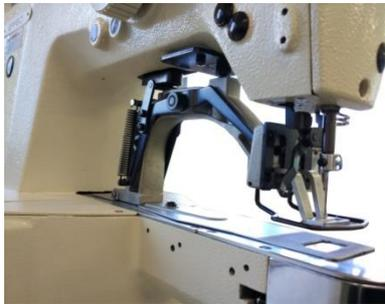
La pinza a movimento magnetico è azionata da un solenoide. Garantisce alte prestazioni ed elevata precisione durante il ciclo di lavoro. E' possibile sostituirla per eseguire travettature verticali.
